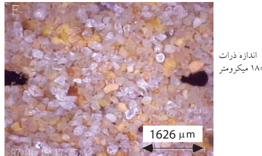
شکل ۱-۱- تصویر میکروسکوپی از شن Toyoura
